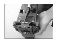
INSERT LONG NOSE PLIERS OR SCREW DRIVER TO CLEAR JAM.
