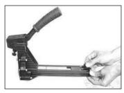
PULL PUSHER (036) BACK TO UPRIGHT POSITION AND GENTLY LET THE PUSHER (036) SLIDE FORWARD AGAINST THE STAPLES. DO NOT LET THE PUSHER (036) SLIDE FORWARD AND STRIKE THE STAPLES AT HIGH SPEED FOR THIS MAY DEFROM THE STAPLES OR DAMAGE THE TOOL.
