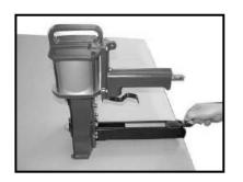
INSERT 2 STICKS OF APPROPRIATE STAPLES INTO THE MAGAZINE (041) FROM BACK . LET THE STICKS SLIDE FORWARD TO THE FRONT OF THE MAGAZINE (041)
