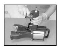
LOOSEN AND TAKE AWAY SET SCREW ( 528 ) WITH 5 mm HEXAGON WRENCH KEY FROM BACK OF MAGAZINE SEAT (037).
