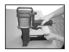
PULL PUSHER (046) BACK TO UPRIGHT POSITION AND GENTLY LET THE PUSHER (046) SLIDE FORWARD AGAINST THE STAPLES. DO NOT LET THE PUSHER (046) SLIDE FORWARD AND STRIKE THE STAPLES AT HIGH SPEED FOR THIS MAY DEFROM THE STAPLES OR DAMAGE THE TOOL.
