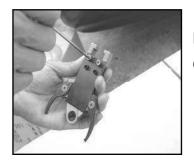
LOOSEN SCREWS (535) WITH 3  ${\rm mn}$  HEXAGON WRENCH KEY . TAKE OFF THE SPRING PIN (537) WITH HAMMER AND 6  ${\rm mn}$  STRAIGHT ROD .
