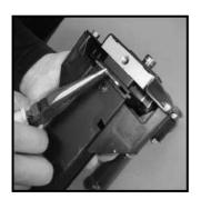
INSERT LONG NOSE PLIERS OR SCREW DRIVER TO CLEAR JAM.
