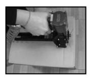
GRASP HANDLE WITH ONE HAND POSITION ON BOX IN LINE WITH THE DESIREDSTAPLE LOCATION . THERE IS A SMALL PROJECTION EITHER SIDE OF THE MAGAZINE SEAT (038) AS AN AID IN LOCATING THE POSITION OF THE STAPLE . (011)
